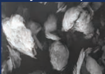
Microcrystalline, SEM at 2000 X
